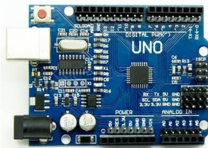
Fig (1); Arduino Uno.
